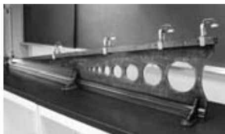
図1：ガリレオが物体の落下実験に使用されたとされている斜面の模型
