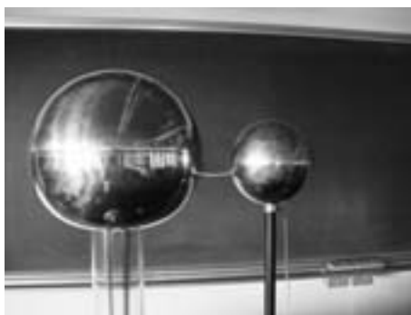
図3：雷の再現，大球と小球の間で放電現象が見えている。
