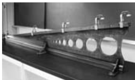
図1：ガリレオが物体の落下実験に使用されたとされている斜面の模型
