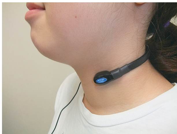
図2 頸部にマイクが密着するように装着する。
