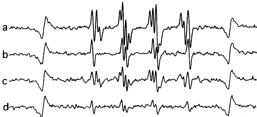
図4 エピネフリン含有塩酸リドカイン添加群にSOD, メタノール, SOD+メタノールを加えて得られたESRスペクトル
